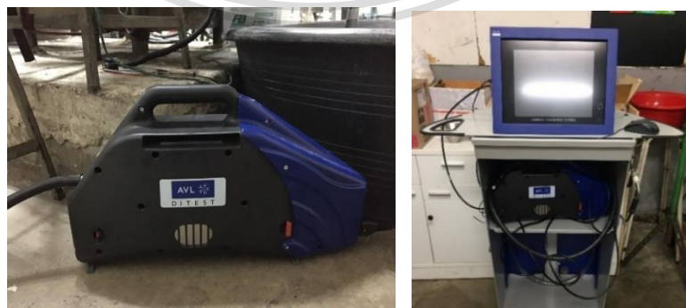
รูปที่ 3.7 (1) เครื่องมือตรวจวัดระบบวัดความทึบแสง (AVL Opacity Meter) และ (2) เครื่องวิเคราะห์ประสิทธิภาพการเผาไหม้ (Gas Analyzer)
