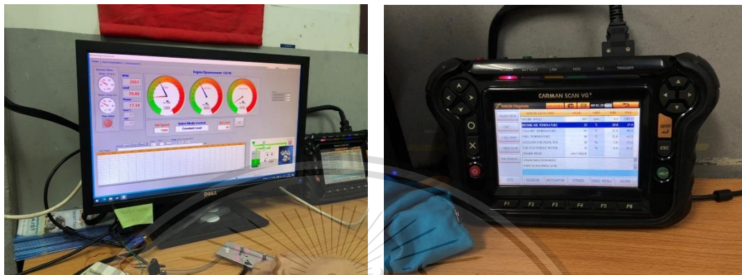
รูปที่ 3.6 ระบบรวบรวมข้อมูล (Data acquisition unit) และ จอแสดงผล (Data acquisition interface)
