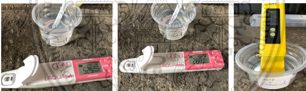
รูปที่ 5.4 แสดงการวัดค่า pH, Conductivity, TDS ของน้ำอ่อน
