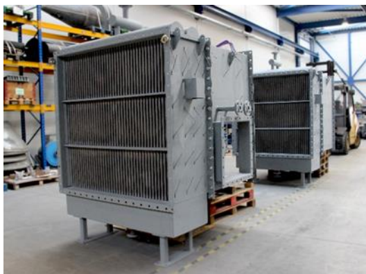
รูปที่ 2.26 เครื่องอุ่นลม (Air Preheater)
