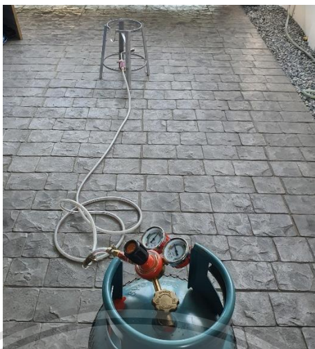
รูปที่ 3.22 การติดตั้งอุปกรณ์ในการทดลองหาอัตราการถ่ายเทความร้อนหัวพ่นไฟ
