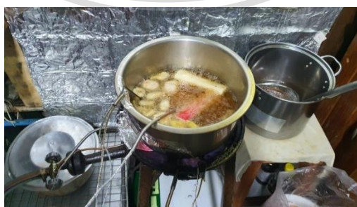
รูปที่ 3.3 จุดวัดอุณหภูมิในการทดลองประสิทธิภาพเตาแรงดันสูง
