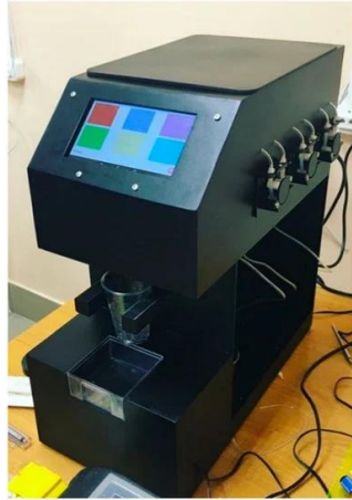
รูป 2.16 ระบบที่พัฒนาขึ้นสำหรับการจ่ายของเหลวที่มีความแม่นยำสูง ที่มา : Vyacheslav et al (2562)
