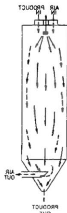
รูปที่ 2.8 การไหลของอากาศภายในเครื่องอบแห้งแบบพ่นฝอย (Masters, 1979)
