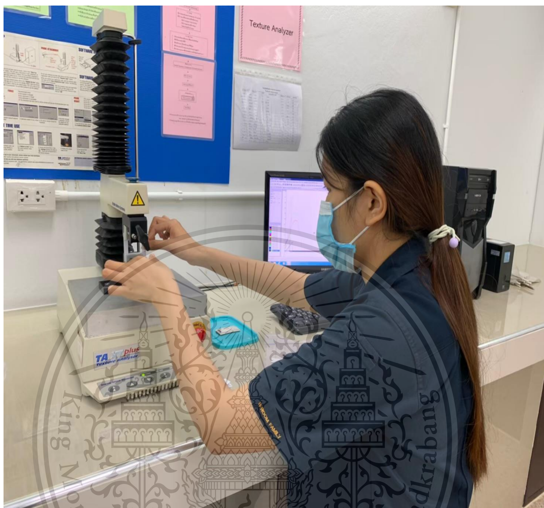
รูปที่ ข. 4 การทดสอบแรงดึงด้วยเครื่องทดสอบแรงดึง (Texture Analyzer)
