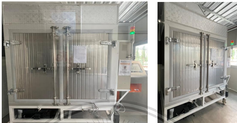
รูปที่ 3.4 เครื่องทำแห้งแบบลมร้อน ระบบควบคุมการทำแห้งอัจฉริยะในผลิตภัณฑ์อาหารแห้ง (สนับสนุน โดยสำนักงานกองทุนสนับสนุนการวิจัย)
