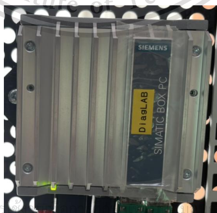
รูปที่ 2.13 ไอโอทีเกตเวย์ รุ่น SIMATIC IPC127E
