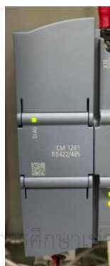
รูปที่ 2.3 โมดูลการสื่อสาร รุ่น CM1241 (RS422/485)
