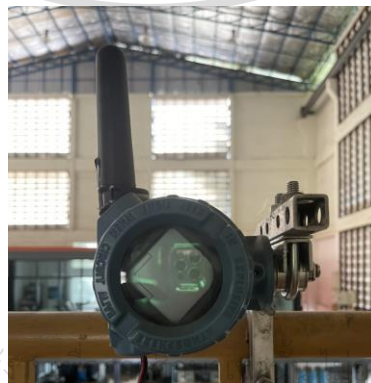
รูปที่ 2.11 ดิสครีตทรานสมิตเตอร์แบบไร้สาย รุ่น 702
