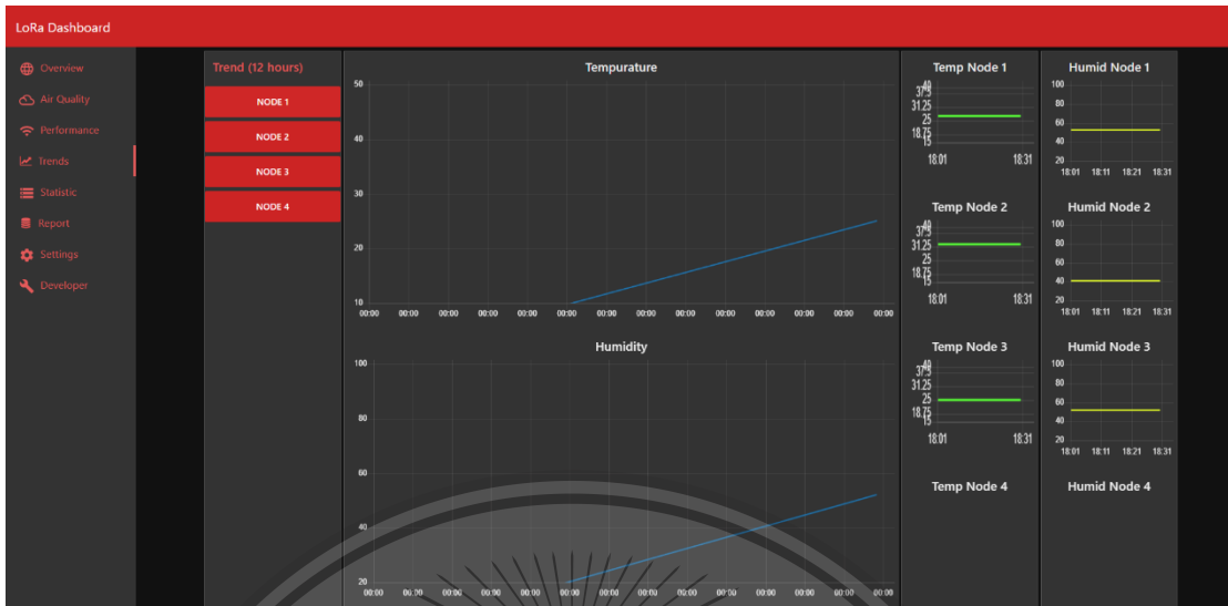
รูปที่ 4.11 กราฟระหว่างอุณหภูมิและความชื้นเมื่อเทียบกับเวลา
