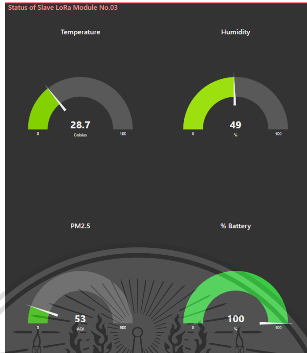
รูปที่ 4.2 ข้อมูลจากโมดูลสเลฟ LoRa หมายเลข 03 ในรูปแบบเกจวัด
