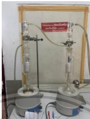
รูปที่ 3.13 การสกัดไขมันโดยวิธีการ Soxhlet Extraction
