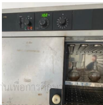
รูปที่ 3.15 ระเหย Hexane อีกครั้งด้วยตู้อบลมร้อน
