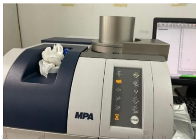
รูปที่ 3.9 วัดการดูดกลืนแสงของกากมะพร้าวคั้นกะทิ
