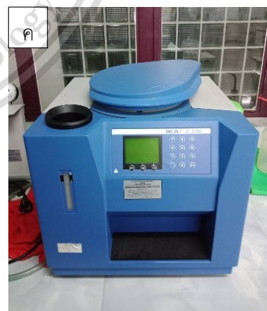
รูปที่ 3.3 การวัดค่าความร้อนด้วยเครื่อง BOMB CALORIMETER ชั่งน้ำหนักชีวมวล (ก) , อัดเม็ดพืช เอกสารนี้เป็นเอกสารที่สงวนไว้สำหรับการใช้งานเพื่อการศึกษาเท่านั้น ไม่อนุญาตให้นำไปเผยแพร่ขึ้นต้นการค้า ตัวอย่างด้วยเครื่อง (ข) , เครื่อง BOMB CALORIMETER (ค) ไม่ว่ากรณีใดๆทั้งสิ้น อีกทั้งห้ามมิให้ตัดแปลงเนื้อหา และต้องอ้างอิงถึงเจ้าของเอกสารทุกครั้งที่มีการนำไปใช้
