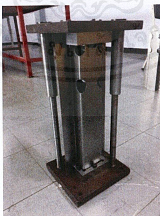
รูปที่ 3.27 ตัวยึดหลังการติดตั้งให้กับตัวดูดซับพลังงาน
