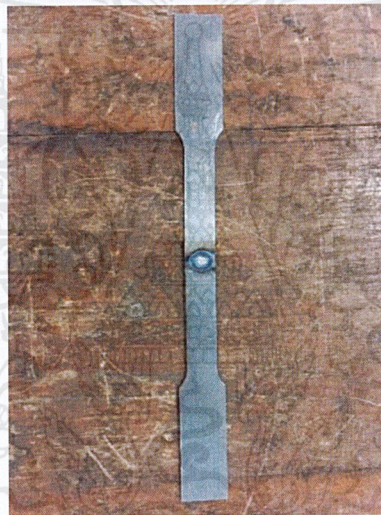
รูปที่ 3.8 ชิ้นงานทดสอบแรงดึงสำหรับใช้ทดสอบความแข็งแรงของรอยเชื่อม
