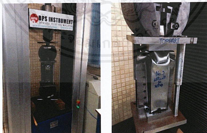
รูปที่ 3.29 การทดสอบแรงอัดกับตัวดูดซับพลังงาน
