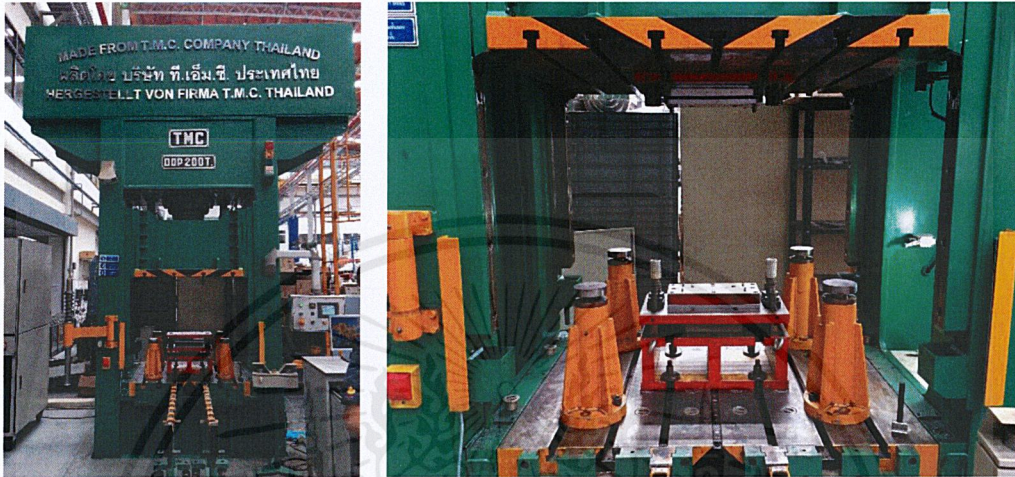
รูปที่ 3.3 เครื่อง Hydraulic pressing machine (TMC DDP 200T)
