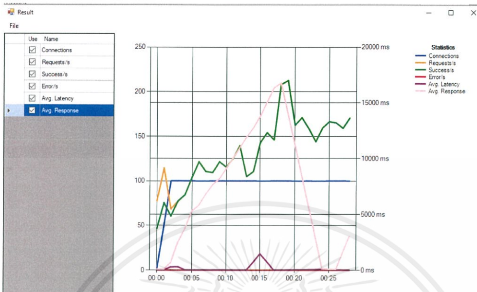
รูปที่ 4.9 กราฟผลลัพธ์ของ Constant Load Test
