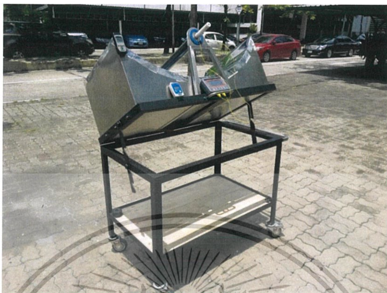
รูปที่ 4.47 แสดงการติดตั้งเตาอบพลังงานแสงอาทิตย์เพื่อให้ความร้อนโดยปรับมุมเอียง 30 องศา
