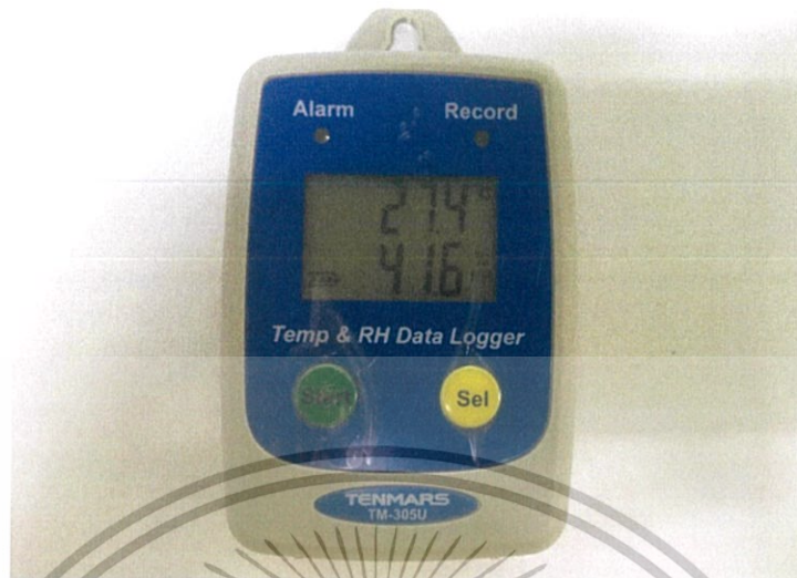
รูปที่ 3.7 แสดงถึงเทอร์โมมิเตอร์แบบเก็บข้อมูล ยี่ห้อ Tenmars รุ่น TM305U
