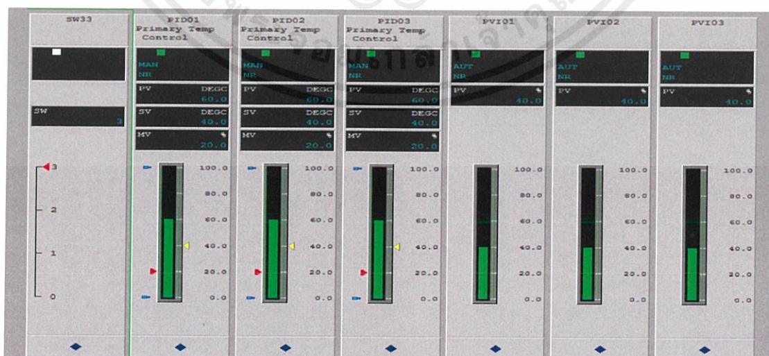
รูปที่ 4.9 Faceplate การทำงานของ ฟังก์ชันบล็อก SW-33 เมื่อตั้งเงื่อนไขให้ค่า SW = 3
