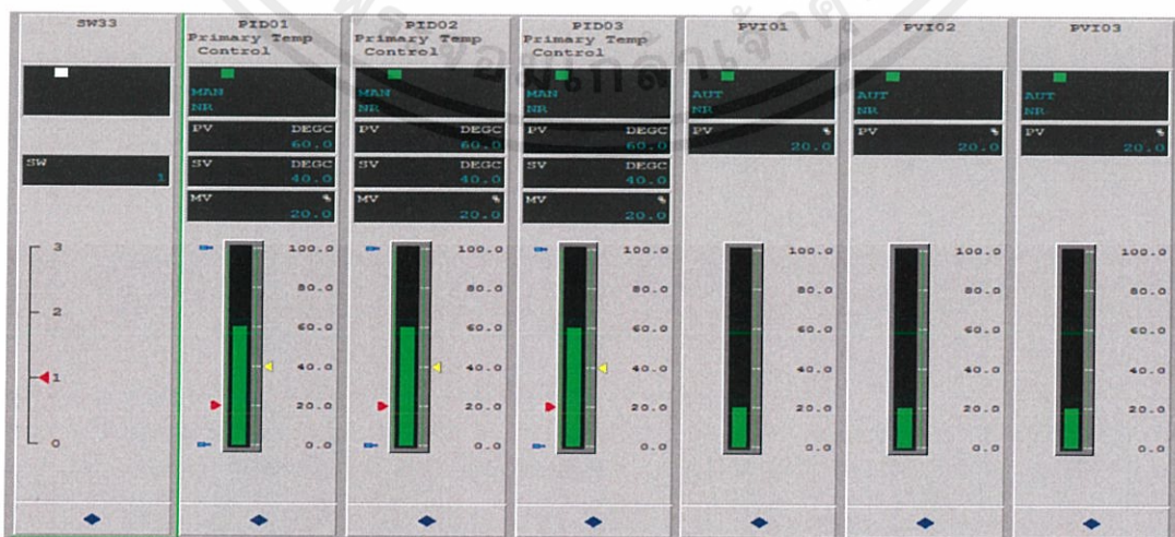
รูปที่ 4.5 Faceplate การทำงานของ ฟังก์ชันบล็อก SW-33 เมื่อตั้งเงื่อนไขให้ค่า SW = 1
