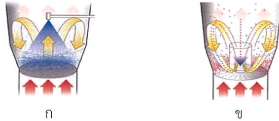
รูปที่ 2.8 แสดงกลไกไมโครเอนแคปซูลชันด้วยเทคนิค air suspension
