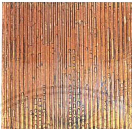
รูปที่ 4.3 แสดงรูปแบบการไหลแบบ slug flow ที่ Re_{SG} = 27 และ Re_{SL} = 79-194
