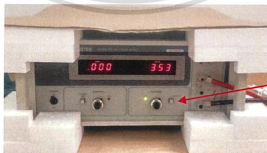
รูปที่ 3.32 แสดงการทำงานของแหล่งจ่ายไฟกระแสตรง
