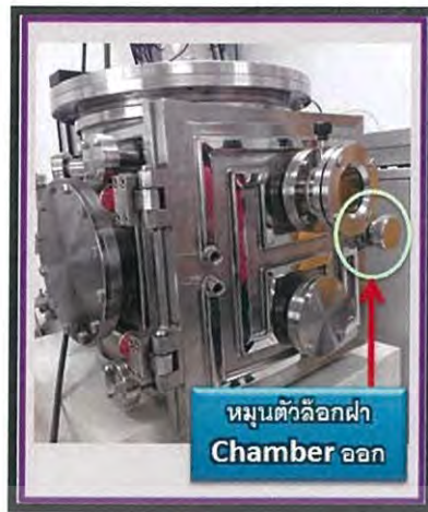
รูปที่ 3.5 การเปิดตัวล็อกฝาห้องสุญญากาศ
