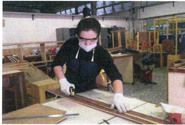
รูปที่ 3.25 ตีเส้นและวัดขนาดไม้อัด
