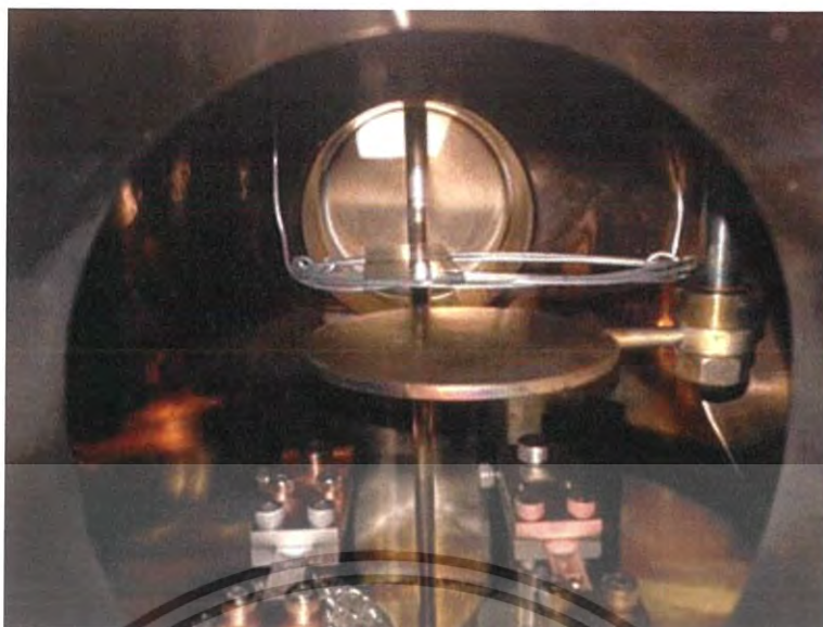
รูปที่ 3.21 ชุดเตอร์ถูกปิดเพื่อป้องกันการเคลือบ
