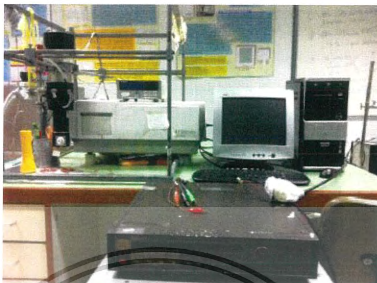
รูปที่ 3.2 อุปกรณ์ที่ใช้ในการศึกษาความสัมพันธ์ระหว่างค่ากระแสไฟฟ้า - แรงดันไฟฟ้า (I-V curve) ที่อุณหภูมิต่างๆ ของฟิล์มบางของสารกึ่งตัวนำ Cd_{1-x}Zn_xSe โดยวิธีการระเหยสารเคมีด้วยความร้อนในระบบสุญญากาศ
