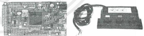
รูปที่ 2.1 (ซ้าย) Arduino DUE (ขวา) หม้อแปลงกระแส 3 เฟส
