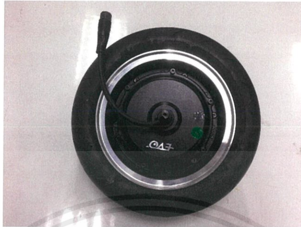
รูปที่ 3.3 มอเตอร์ไฟฟ้ากระแสตรงแบบไม่ใช้แปรงถ่าน (Brushless DC Motor)
