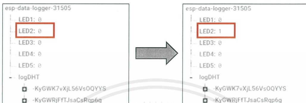
รูปที่ 4.11 ผลการเปลี่ยนแปลงสถานะบนฐานข้อมูลเมื่อเปิดปิดปั้มน้ำผ่านแอปพลิเคชัน
