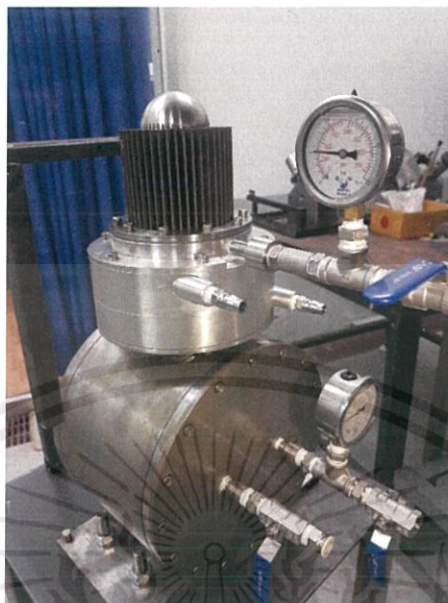
รูปที่ 5.8 แสดงการทดสอบการรั่วของอากาศ
