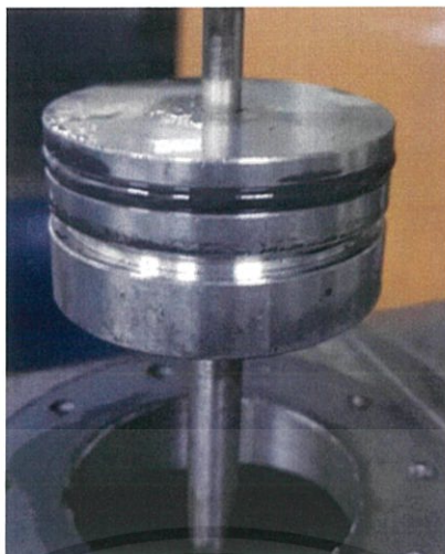
รูปที่ 5.13 แสดงลูกสูบกำลังที่ถูกถอดแหวนไอรังออกหนึ่งวง
