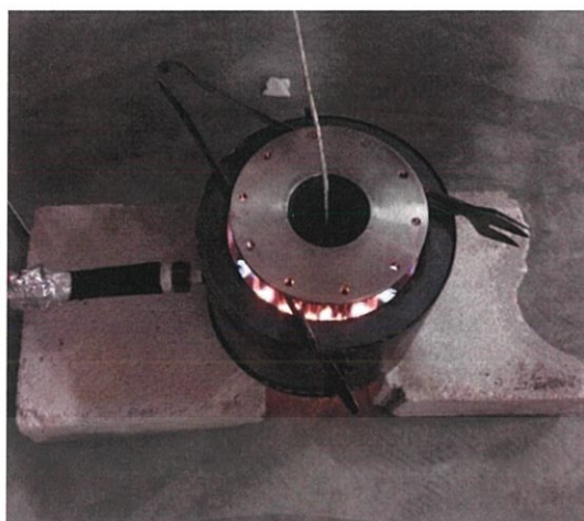
รูปที่ 5.11 แสดงการทดสอบการถ่ายเทความร้อนของฮีทเตอร์
