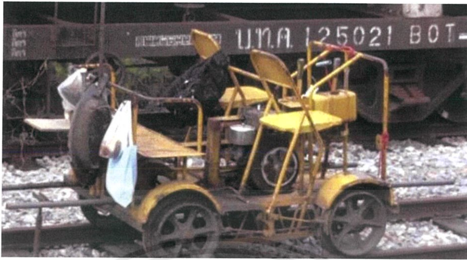
รูปที่ 2.4 แสดงรถตรวจทางขนาดเล็กสำหรับการนั่งตรวจทางทั่วไป
