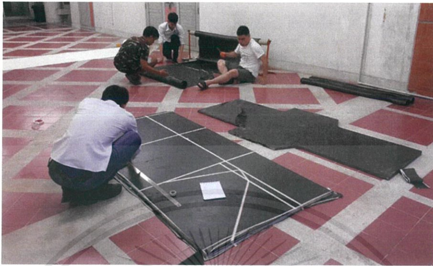
รูปที่ 5.20 เขียนแบบชิ้นงานตามที่ออกแบบ
