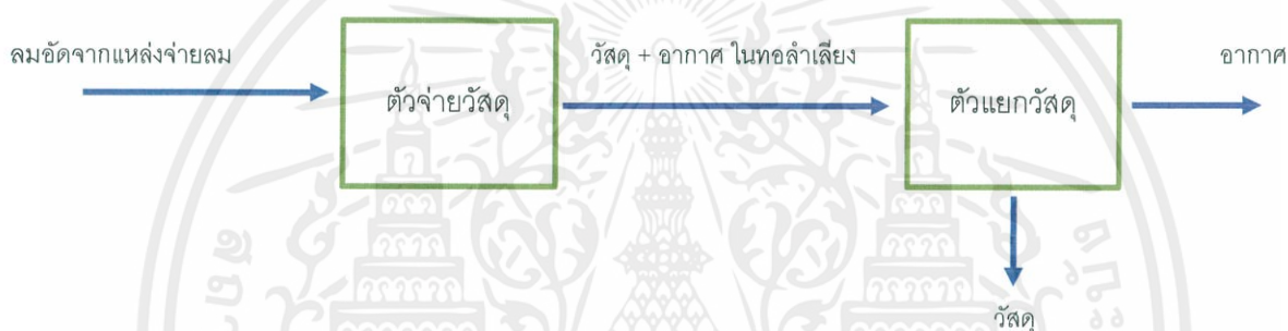
รูปที่ 2.1 ส่วนประกอบเบื้องต้นที่สำคัญของระบบขนถ่ายวัสดุด้วยลม
