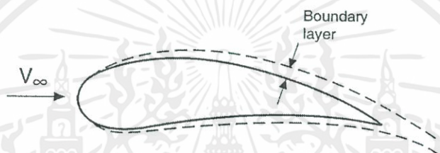
รูปที่ 3.12 Boundary layer ที่เกิดขึ้นบน Aerofoil
