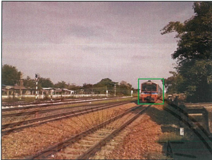
รูปที่ 3.3 ภาพแสดงการตรวจจับรถไฟด้วย วิธี Haar Cascade
