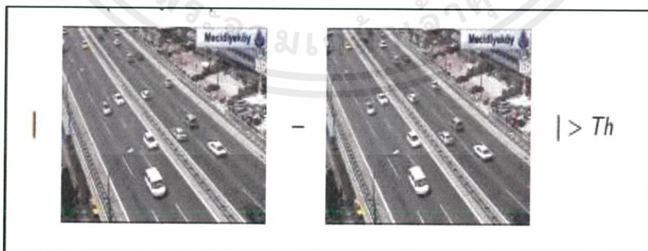
รูปที่ 2.10 ภาพแสดงความแตกต่างของพิกเซล (Threshold) (ภาพจาก เว็บไซต์ Open Source Computer (OpenCV) [16])
