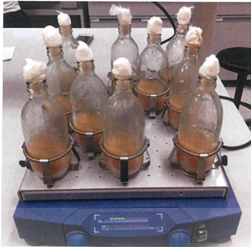
รูปที่ 3.1 หัวเชื้อเริ่มต้น ปริมาตร 100 มิลลิลิตร เขย่าที่ความเร็วรอบ 200 รอบต่อนาที ที่ อุณหภูมิห้อง เป็นเวลา 24 ชั่วโมง
