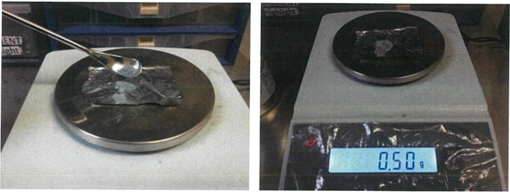
รูปที่ 3.16 ชั่ง Zinc powder ด้วยเครื่องชั่งสาร
