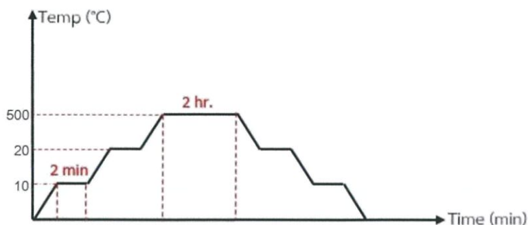
รูปที่ 3.23 สเต็ปการเพิ่ม-ลด อุณหภูมิ
