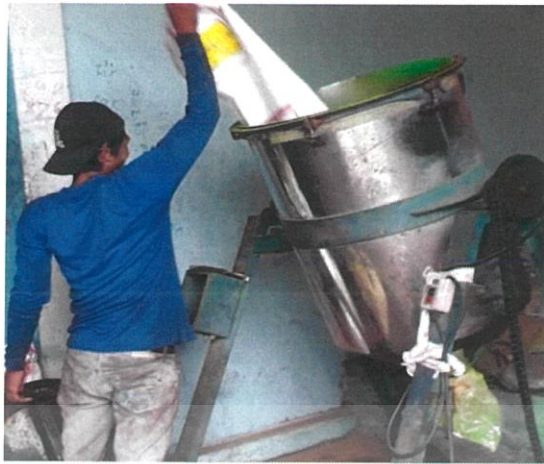
รูปที่ 3.9 พนักงานนำวัตถุดิบเทลงในเครื่องผสมสี
