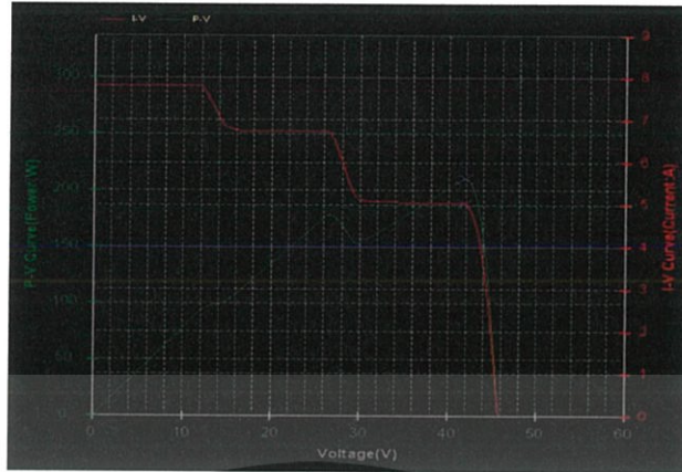
รูปที่ 4.63 กราฟแผงที่เกิด Hot spot
