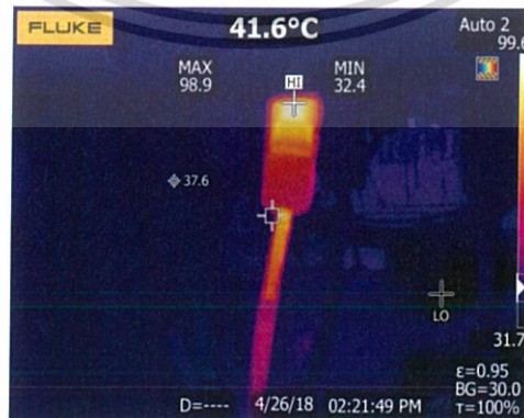
รูปที่ 3.35 ความร้อนหัว MC4
