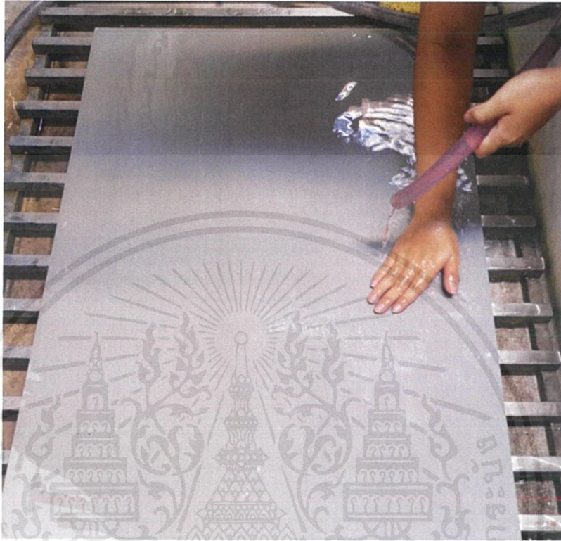
ภาพที่ 3.67 ภาพการทำทำความสะอาดหน้าเพลต
