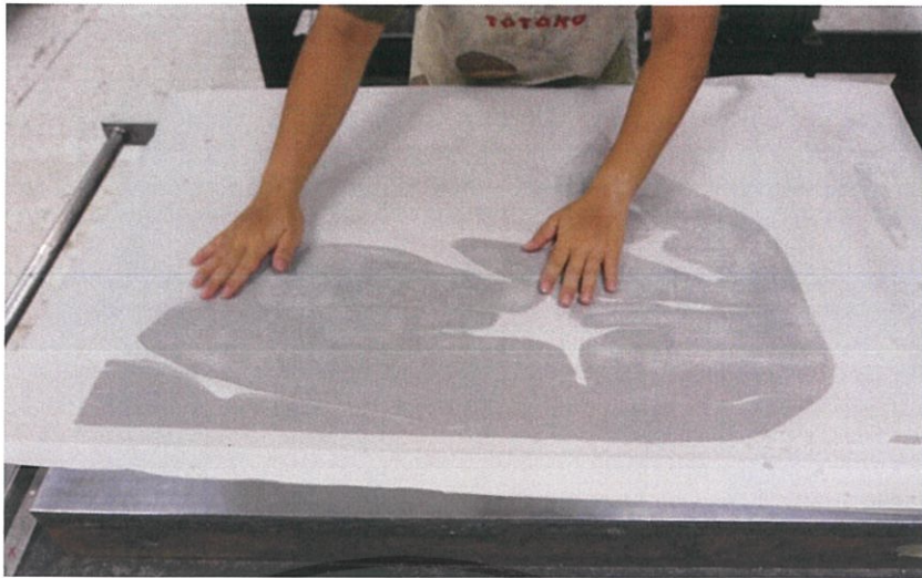
ภาพที่ 3.68 ภาพการทำเพลทให้แห้ง
