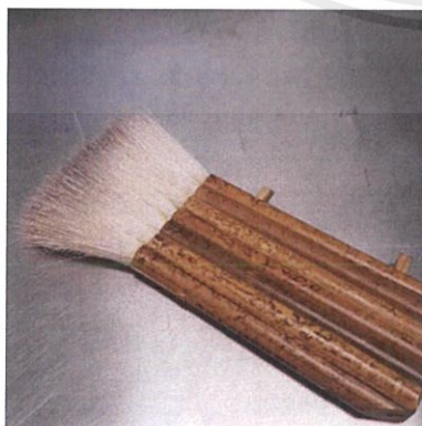
ภาพที่ 3.41 แปรงสำหรับปิดเศษไข
