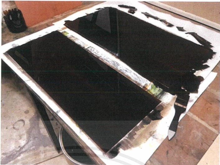
ภาพที่ 3.37 ขณะรอเพลดทองแดงที่ทำด้วยวานิชแห้ง
