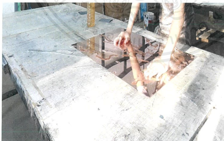
ภาพที่ 3.2.18 ภาพการขัดแม่พิมพ์กับน้ำสะอาด
