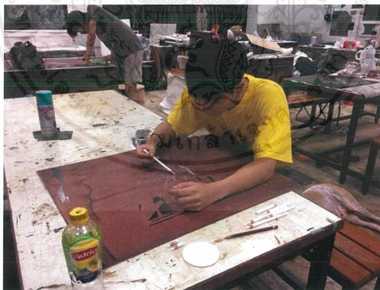
ภาพที่ 3.34 เขียนไขในส่วนของค้ันไม้และปีควานึชเพ็อนำไปแซ่กรคตามเวลาทีเตร็ยมไว้
