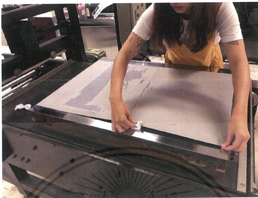
ภาพที่ 3.67 ภาพการทำความสะอาดขอบเพลทและแท่นพิมพ์
