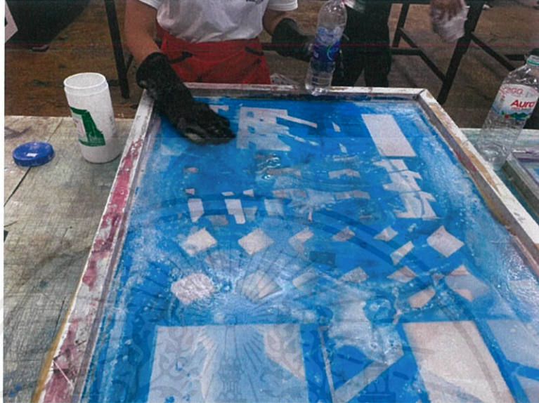
ภาพที่ 3.26 นำผงคลอรีนผสมน้ำเทแล้วถูให้ทั่วบล็อก
