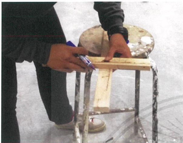
ภาพที่41,42 วัดไม้เพื่อทำโครงด้านในก่อนประกอบและตัดในแต่ละส่วนตามแบบร่าง
