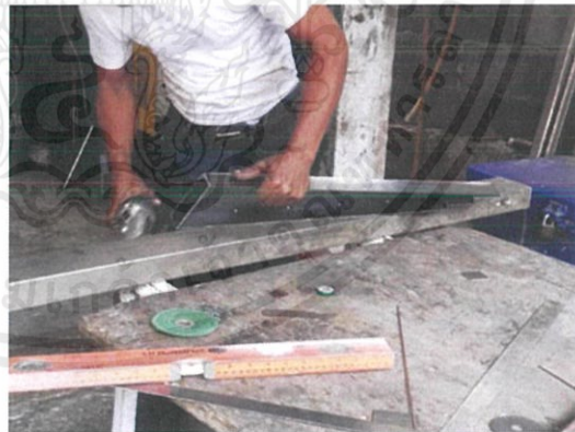
ภาพที่46อีกหนึ่งวิธีการประกอบสร้างโดยใช้เหล็กเป็น โครงสร้างนำแผ่นเหล็กมาตัดตามตัวต้นแบบและนำมา เชื่อมติดด้วยกัน มีการขัดเจียเพื่อให้หน้าเหล็กเรียบเนียน
