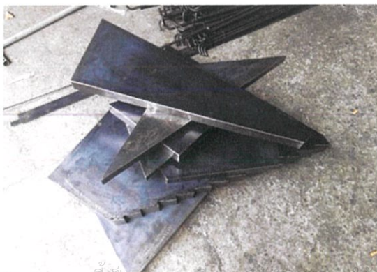
ภาพที่46อีกหนึ่งวิธีการประกอบสร้างโดยใช้เหล็กเป็น โครงสร้างนำแผ่นเหล็กมาตัดตามตัวต้นแบบและนำมา เชื่อมติดด้วยกัน มีการขัดเจียเพื่อให้หน้าเหล็กเรียบเนียน
