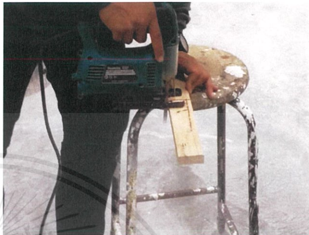
ภาพที่41,42 วัดไม้เพื่อทำโครงด้านในก่อนประกอบและตัดในแต่ละส่วนตามแบบร่าง
