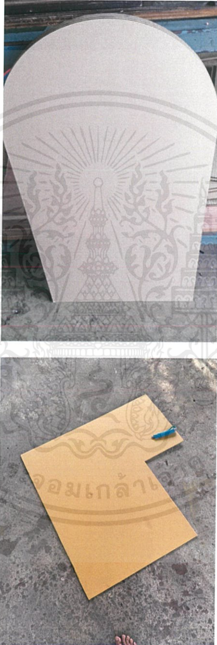
ภาพ 5.26 การ laser cut กระดาษลูกฟูก
