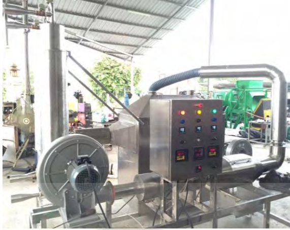
ภาพที่ 4.2 ระบบอบแห้งแบบลมร้อนร่วมกับสารดูดความชื้น
