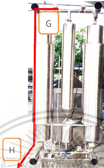
ภาพที่ 3.15 ทิศทางการไหลของอากาศผ่านหอดูดความชื้นเพื่อกำจัดความชื้นออกจากซิลิกาเจล
