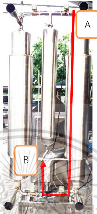
ภาพที่ 3.16 ทิศทางการไหลของอากาศผ่านหลอดความชื้นเพื่อลดความชื้นของอากาศ
