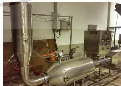
ภาพที่ 3.1 ส่วนประกอบของชุดทดลองเบื้องต้น (A) ประกอบด้วย หอดูดความชื้น, ท่อกระจายลม, อุปกรณ์ทำ
