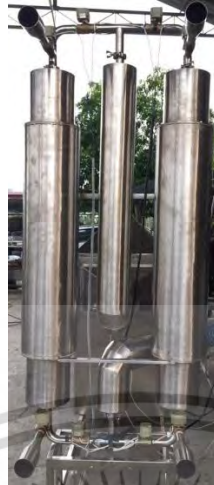
ภาพที่ 3.12 หอดูดความชื้นแบบคอลัมน์คู่
