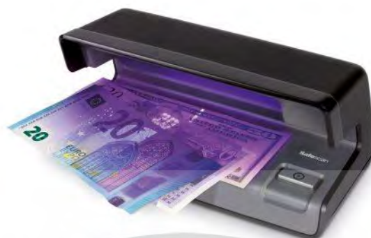
รูปที่ 3.10 การประยุกต์ใช้แสงอัลตราไวโอเล็ตในการตรวจสอบธนบัตร : www.uksecuritysystems.com
