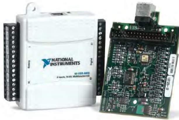
รูปที่ 4.24 การ์ดอินเตอร์เฟสของบริษัท National Instruments รุ่น USB-6009 : www.researchgate.net
