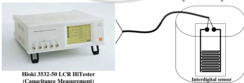
รูปที่ 5.12 การวัดค่าคาปาซิแตนซ์ของเซนเซอร์แบบอินเตอร์ดิจิตอลในของเหลวที่ใช้ในการแช่อาหาร
