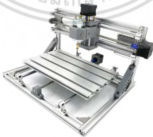
รูปที่ 4.18 ตัวอย่างของเครื่องซีเอ็นซีขนาดเล็ก : www.banggood.com
