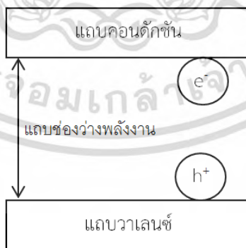
ภาพที่ 2.1 การเกิดช่องว่างของอิเล็กตรอน และ โฮล จากการกระตุ้นด้วยพลังงานจากแสง
