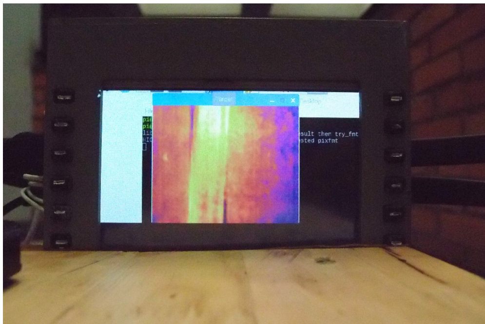
รูปที่ 4.9 ผลการถ่ายภาพความร้อนที่เกิดขึ้นกับรางโดยการให้ความร้อนกับราง(ผิวดปกติ)
