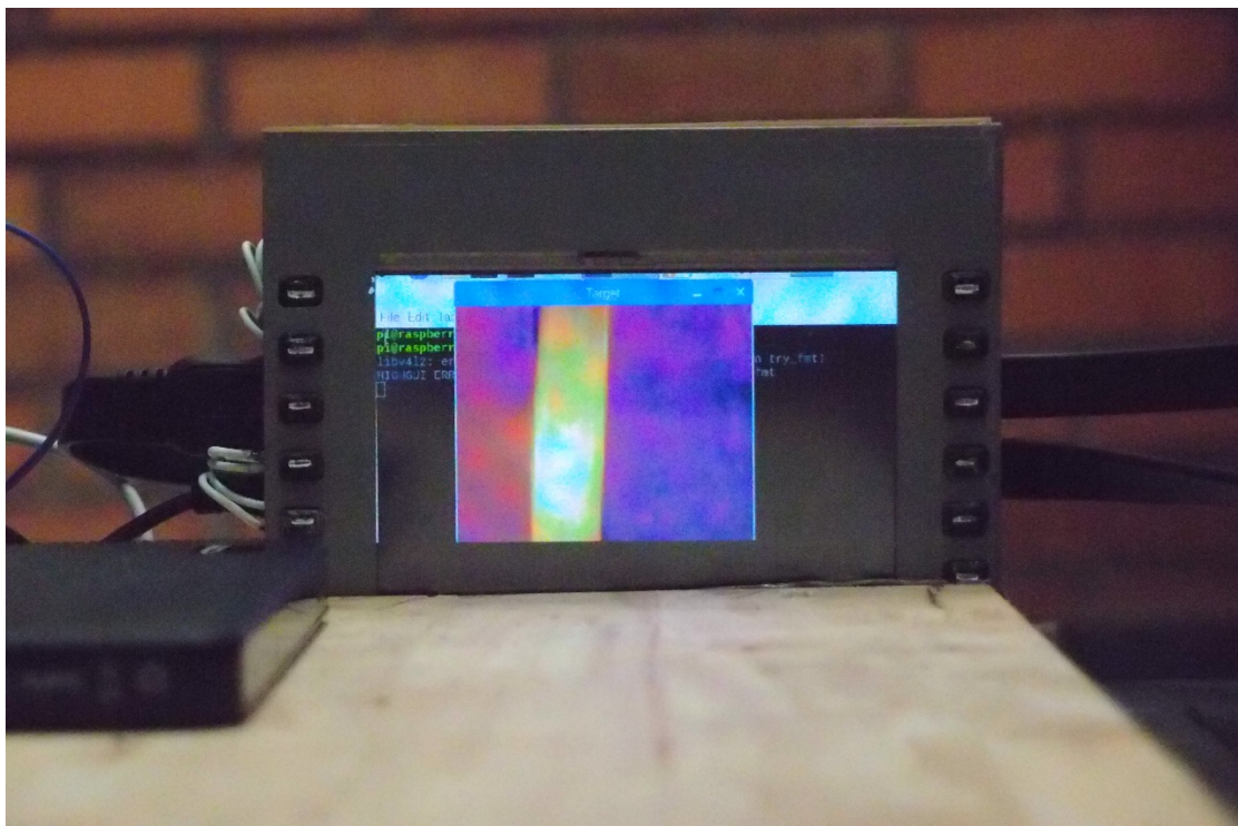
รูปที่ 4.7 ผลการถ่ายภาพความร้อนที่เกิดขึ้นกับรางโดยการให้ความร้อนกับราง(ผิดปกติ)
