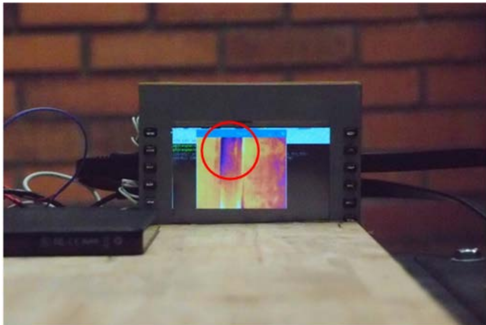
รูปที่ 4.3 แสดงผลความร้อนที่เกิดบริเวณพื้นผิวของราง
