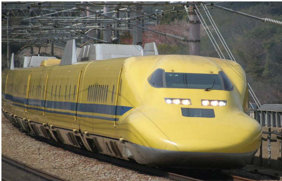
รูปที่ 1 แสดงรถไฟฟ้า สำหรับตรวจสอบระบบทางรางในประเทศญี่ปุ่น Dr. Yellow
