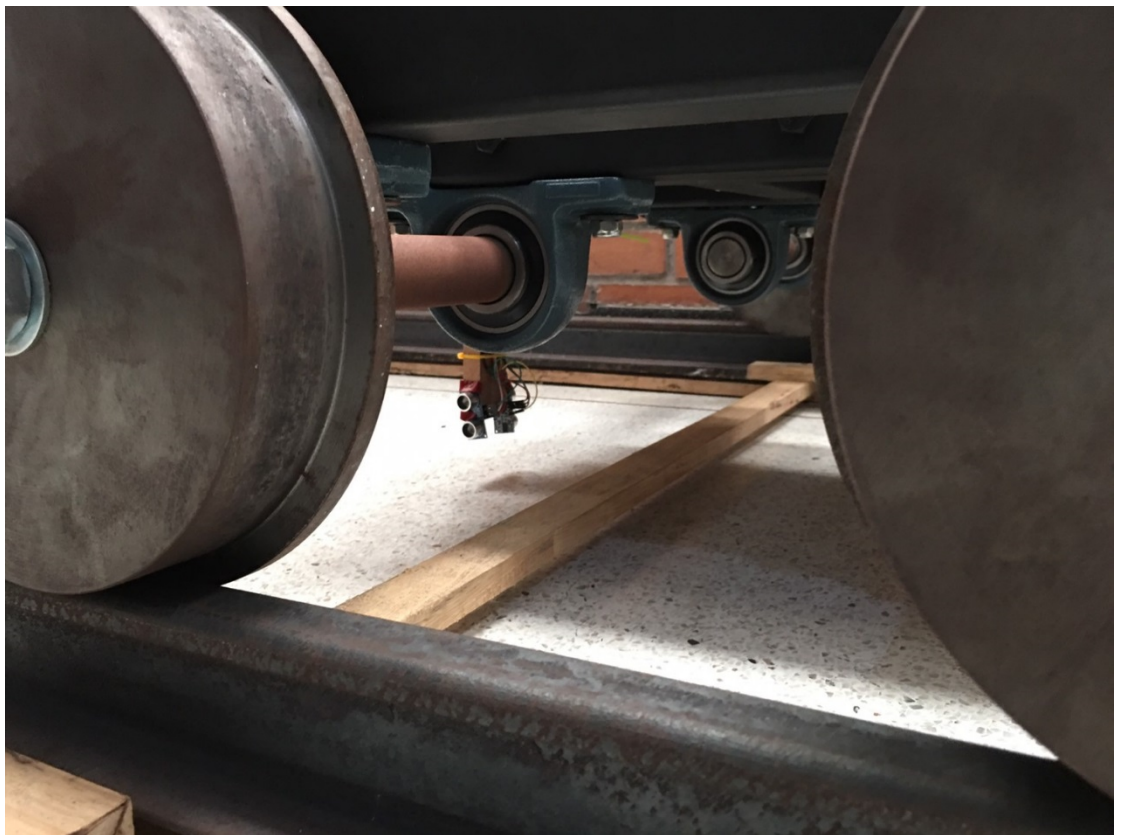
รูปที่ 3.10 แสดงรถตรวจรางต้นแบบติดตั้งชุดวัดระยะทางอัลตราโซนิก
