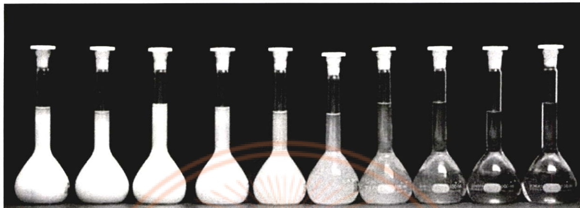
รูปที่ 2.4 น้ำที่มีความขุ่นระดับต่างๆ (ภาพด้านซ้ายคือน้ำที่มีความขุ่นสูง ขวามือคือน้ำที่มีความขุ่นต่ำ:
